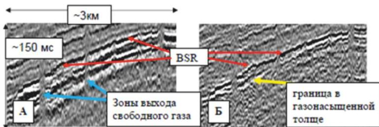
Рис. 7. Фрагмент сейсмических данных до (А) и после (Б) подавления волн-спустников [1]
